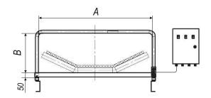
Предназначены для обнаружения посторонних металлических включений (как черных так и цветных металлов и марганцевистой стали) в потоках неметаллических продуктов транспортируемых конвейерной лентой с целью защиты технологического оборудования от повреждений. Могут работать на конвейерных лентах, стыки которых соединены металлическими элементами.
