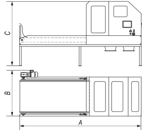
Предназначен для сортировки полимеров по типам с использованием излучения ближнего инфракрасного диапазона.
