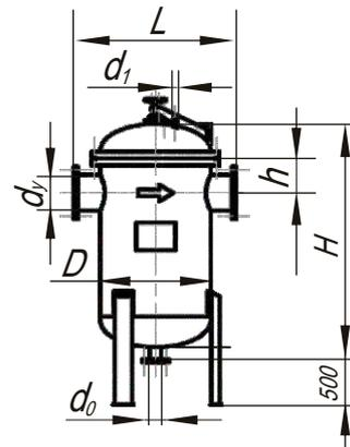
Предназначены для очистки воды от различных нерастворимых примесей в системах водо- и теплоснабжения, охлаждения, оборотного водоснабжения и др.
