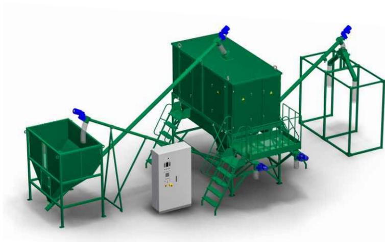
Предназначены для сухого высокоэффективного разделения материалов, которые отличаются электрическими свойствами:
