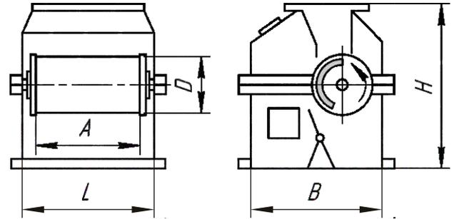
Предназначены для сухого обогащения рудных и нерудных материалов, а также для очистки различных немагнитных материалов от магнитных примесей.
