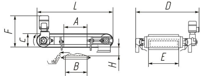
Предназначены для извлечения ферромагнитных примесей и случайных металлических предметов (болтов, гаек и др.) из сыпучих материалов, перемещаемых ленточным конвейером.
