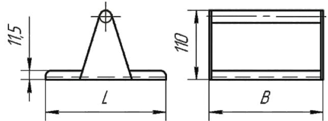
Предназначены для извлечения ферромагнитных примесей из жидких масс, суспензий.
