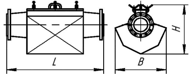
**Предназначены** для извлечения ферромагнитных примесей из сыпучих материалов, перемещаемых с помощью пневмотранспорта.
