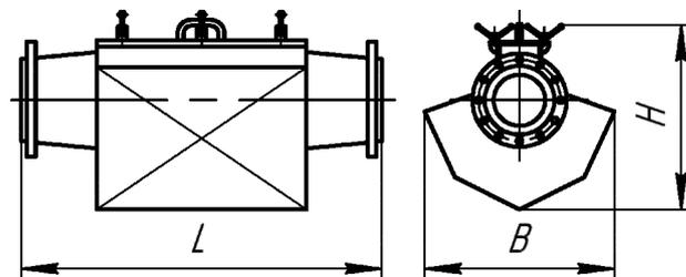
**Предназначены** для извлечения ферромагнитных примесей из сыпучих материалов, перемещаемых с помощью пневмотранспорта.
