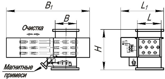
Предназначены для высокоэффективной магнитной сепарации сыпучих материалов фракции до 5 мм без остановки технологического процесса.
