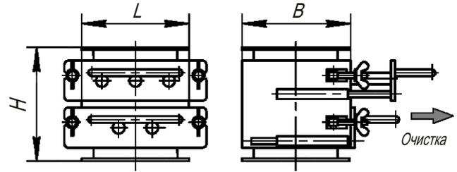
Предназначены для высокоэффективной магнитной сепарации сыпучих продуктов фракции до 5 мм.
