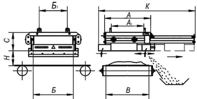
Предназначены для извлечения ферромагнитных примесей и случайных металлических предметов (болтов, гаек и др.) из сыпучих материалов, перемещаемых ленточным конвейером.
