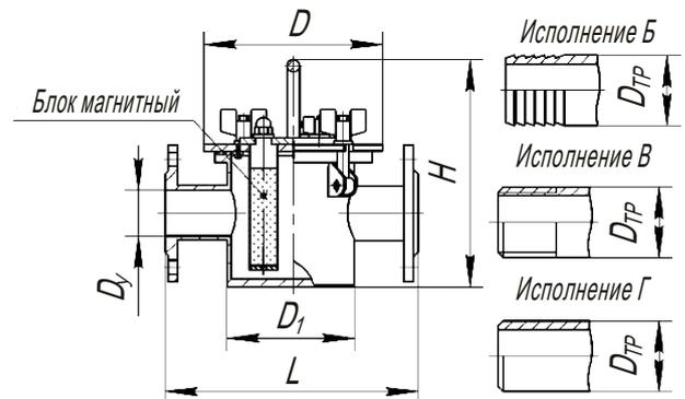
Предназначены для очистки жидких продуктов от ферромагнитных примесей.
