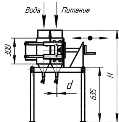
Предназначены для удаления ферромагнитных и парамагнитных материалов из жидких масс и суспензий.
