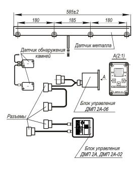
Предназначены для обнаружения как ферромагнитных металлических так и габаритных не металлических(камни) предметов (ДМП2А-06).
