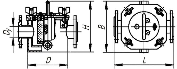
Предназначены для очистки жидких продуктов, склонных к затвердеванию, от ферромагнитных примесей.
